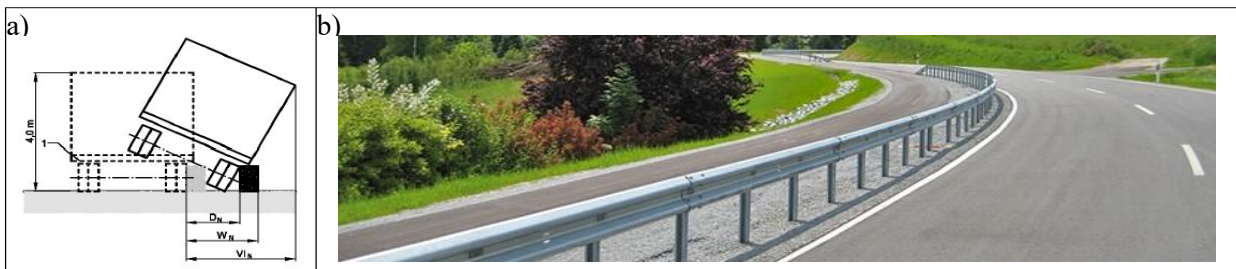
Рисунок 1 - Функціональні особливості захисних бар'єрів: а) динамічне відхилення (DN), робоча ширина (WN) та вторгнення транспортного засобу (VIN), б) захисний бар'єр EASY-RAIL 1,33 смуга, що розділяє проїжджі частини, з протилежними напрямками руху [44].
